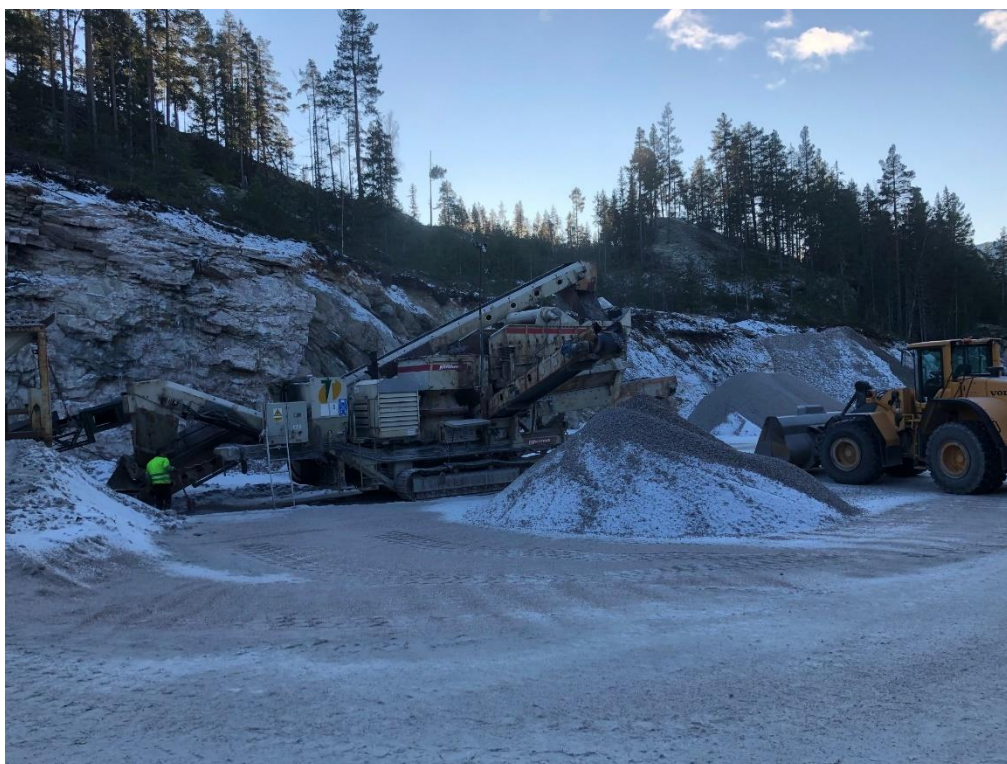
Figur 5: Det foregår uttak langs med vegen. Legg merke til hvor kort veg det er til fast fjell til venstre på bildet.
